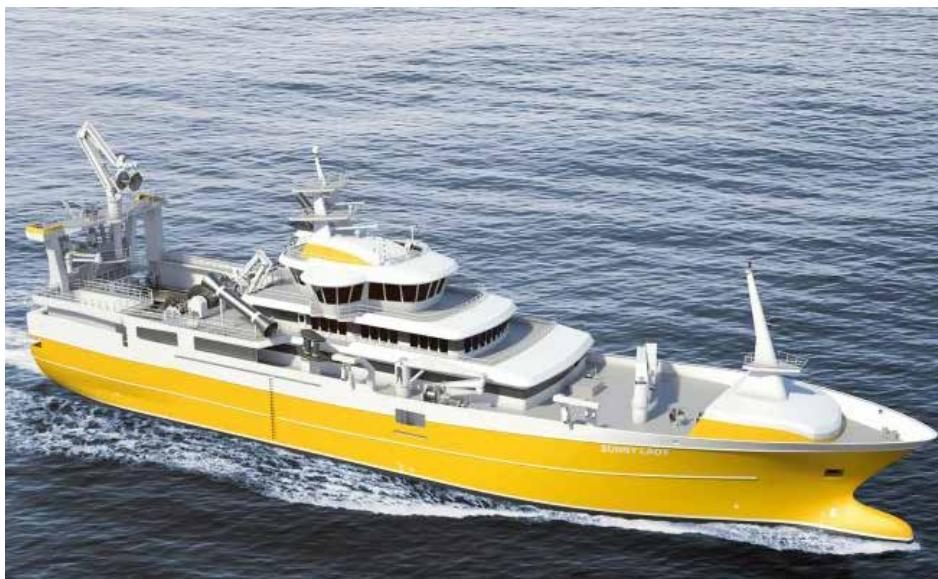
BESTILT: Teige Rederi byggjer ny kombinert ringnotsnurpar og trålar, designa og utvikla av Salt Ship Design på Stord. Sunny Lady skal byggast ved Cemre-verftet i Tyrkia. ILLUSTRASJON SALT SHIP DESIGN
