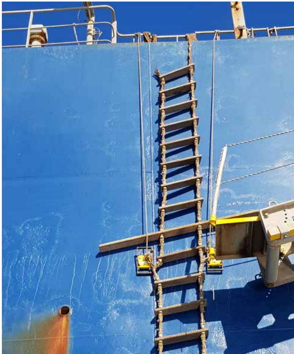
FARLEG: Det kan fort oppstå farlege situasjonar dersom leiderane ikkje er sikra forsvarleg.
