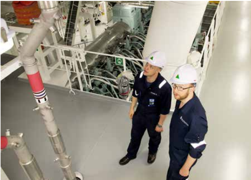
INTERESSANT: Tur/returrøret som frakter metanolen mellom dagtanken og hovedmotoren blir studert av Kristoffer Tyvik (f.v.) og Kolbjørn Berge (t.h.).
