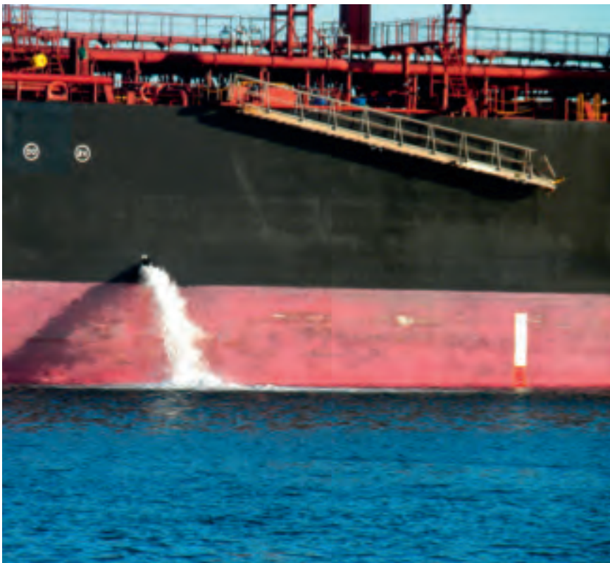
TØMMER: Målet med ballastvannkonvensjonen er å hindre at fremmede marine arter blir spredd når skip tømmer tankene med ballastvann før de laster om bord olje eller gods.
