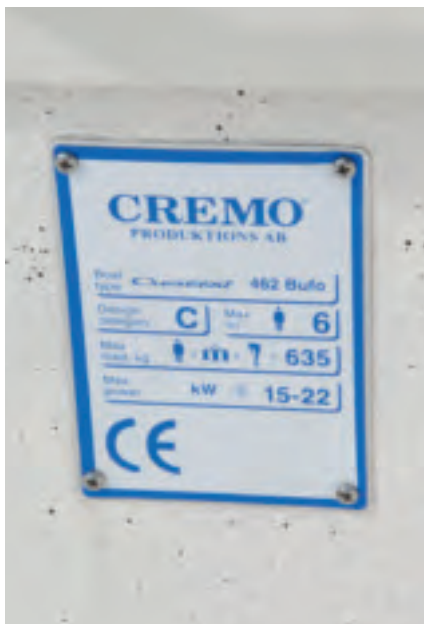
CE-MERKET: Fritidsbåter skal merkes med et produsentskilt. Skiltet skal være plassert lett synlig, og blant flere opplysninger inneholde symbolet «CE», slik vi ser på dette bildet. FOTO: BJARTE AMBLE
