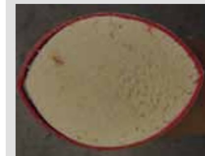
SLIK SKAL DET SE UT. Etter immersjonstesten skar testlaboratoriet opp bøyen for å sjekke at alt var i orden.
