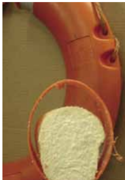
FARLIG FEIL. På denne oppskårne livbøyen kan man tydelig se manglende skumfylling.
