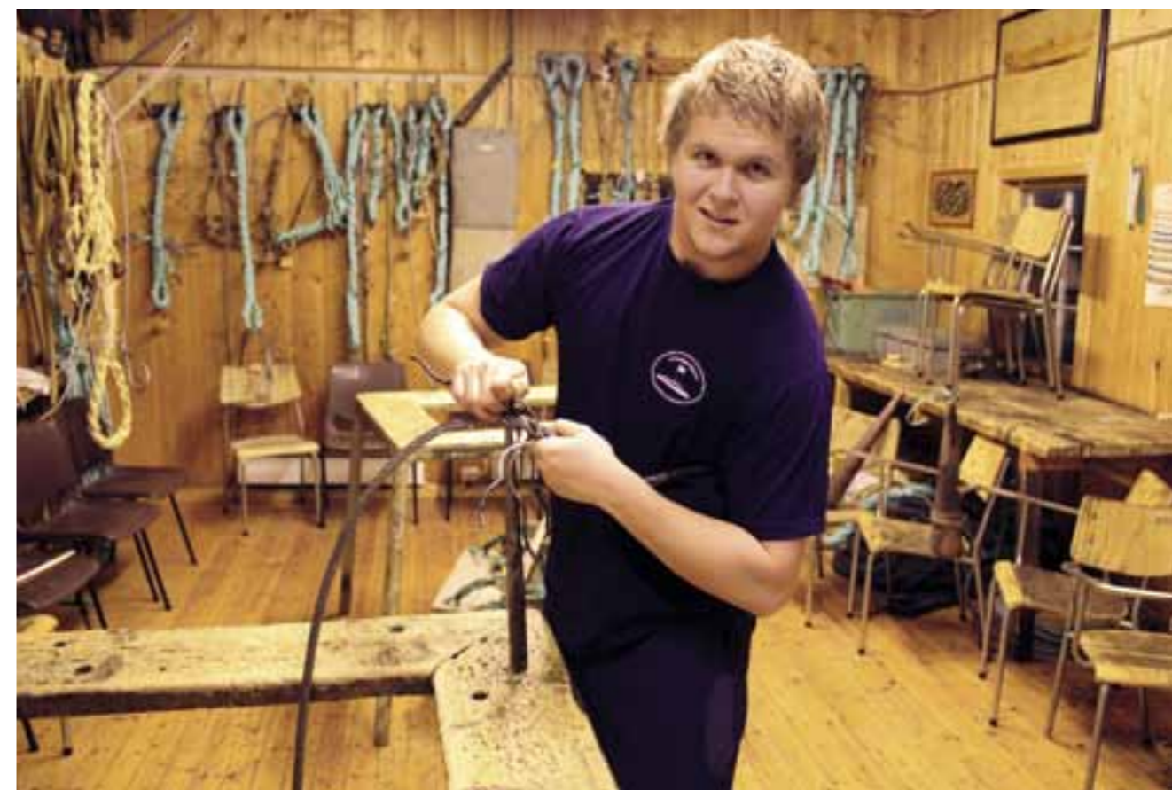
SPLEISING. Kristoffer Søvik i gang med spleising av vaier.
