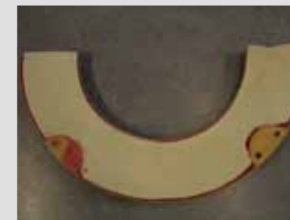
SLIK SKAL DET SE UT. Etter immersjonstesten skar testlaboratoriet opp bøyen for å sjekke at alt var i orden.
